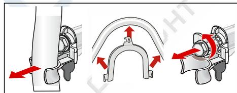
4. Извлечь сетевой кабель из креплений. Снять втулки.
