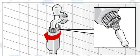
6. Чистка фильтра на задней стенке прибора: Снять шланг с задней стенки прибора, Извлечь фильтр с помощью плоскогубцев и прочистить его.
